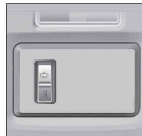
Рис. 30. Передний плафон оборудования салона
