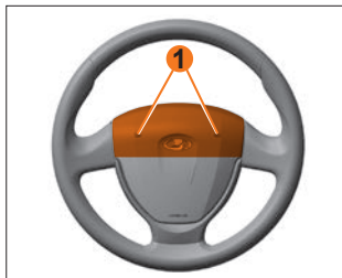
Рис. 6д. Рулевое колесо с НПБВ (в варианном исполнении)
