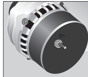
Рис. 77. Клемма «В+» генератора
