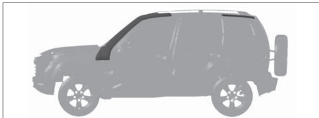
Рис. 35. Шноркель (в варианном исполнении)
