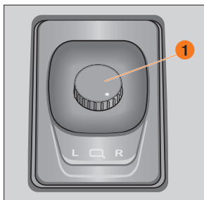
Рис. 28. Блок управления наружными зеркалами
