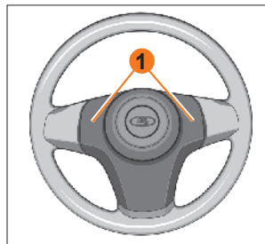
Рис. 6а. Рулевое колесо (в вариантном исполнении)
